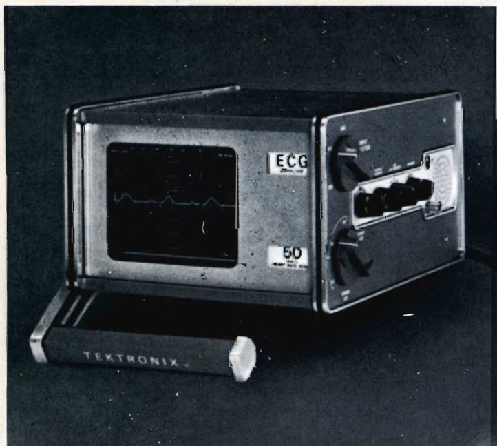
Fig. 5 - Oscillografo Tektronix 410 (Silverstar) per encefalogrammi, elettrocardiogrammi e controllo delle pulsazioni.
